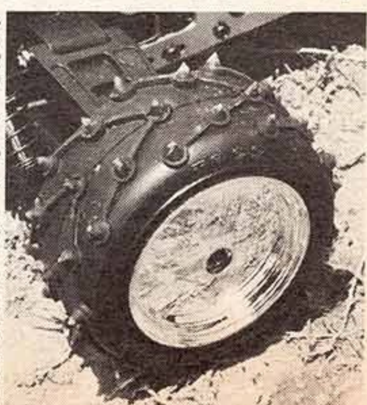
⇒ Vパターンにピン・スバイクを組み合わせたタイヤ。ホイルは金メッキされている。フロント・ホイールにワンウェイ・クラッチがはいっている。独特なナックルに注目。
